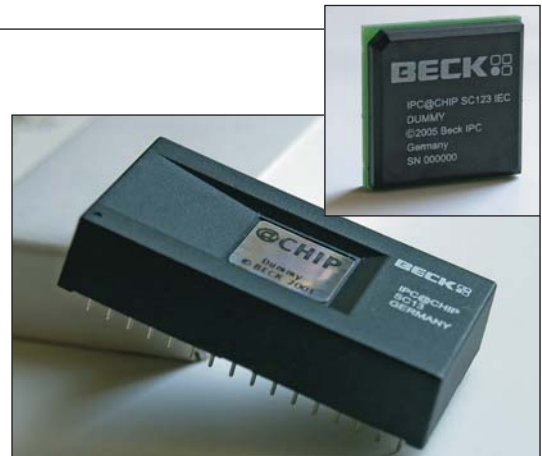
Рис. 1. BECK IPC@CHIP – уникальный микроконтроллер, обладающий большинством функций PC-совместимого компьютера
