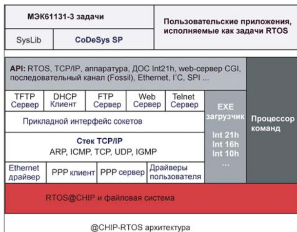
Рис. 3. Максимально полный вариант RTOS включает поддержку внешнего флэш-диска, TCP/IP, PPP-клиента и сервера, серверы Telnet, FTP и веб
